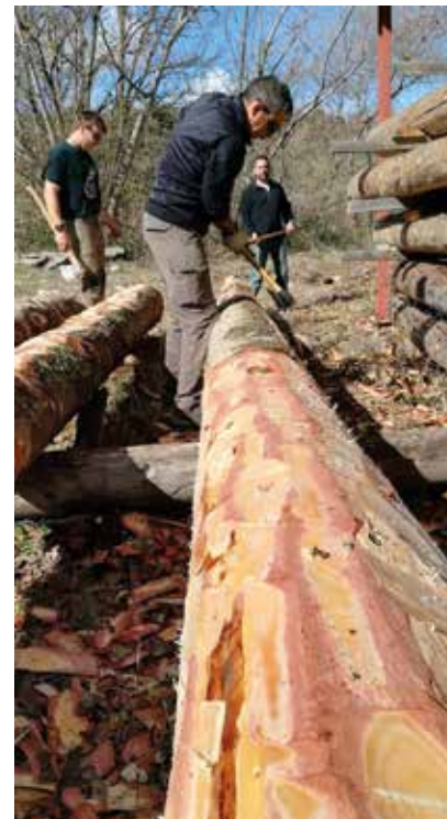
Distintos momentos de la construcción de la navata (remallar, pelar, construir trampas...). Fotos: Nabateros del Sobrarbe (izda.) y Mercedes López Romero (arriba) (Navateros de la Val d'Echo).
